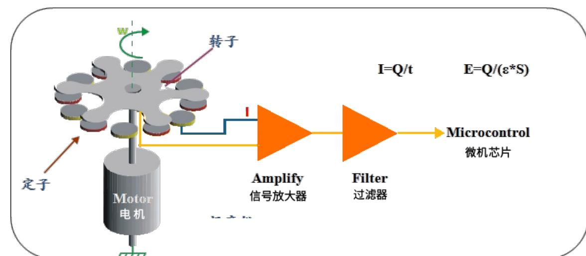
场磨式大气电场仪测量原理模型
